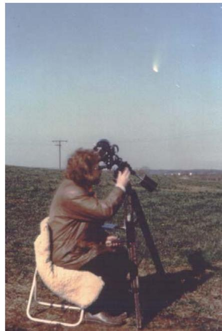
**Abb. 14:** Kometenfotografie auf freiem Felde: der Autor bei nächtlicher Arbeit im Mondlicht mit Pentax-Teleobjektiv 500 mm auf nachgeführtem Teleskop. Reiferscheid/Eifel, 1997 Mai 2, 23:07 Uhr.
